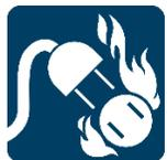
No conecte el generador a un tomacorriente de la casa o al panel de cortacircuitos para evitar retroalimentación. Use cables de extensión de servicio pesado para conectar los electrodomésticos a las salidas del generador.
